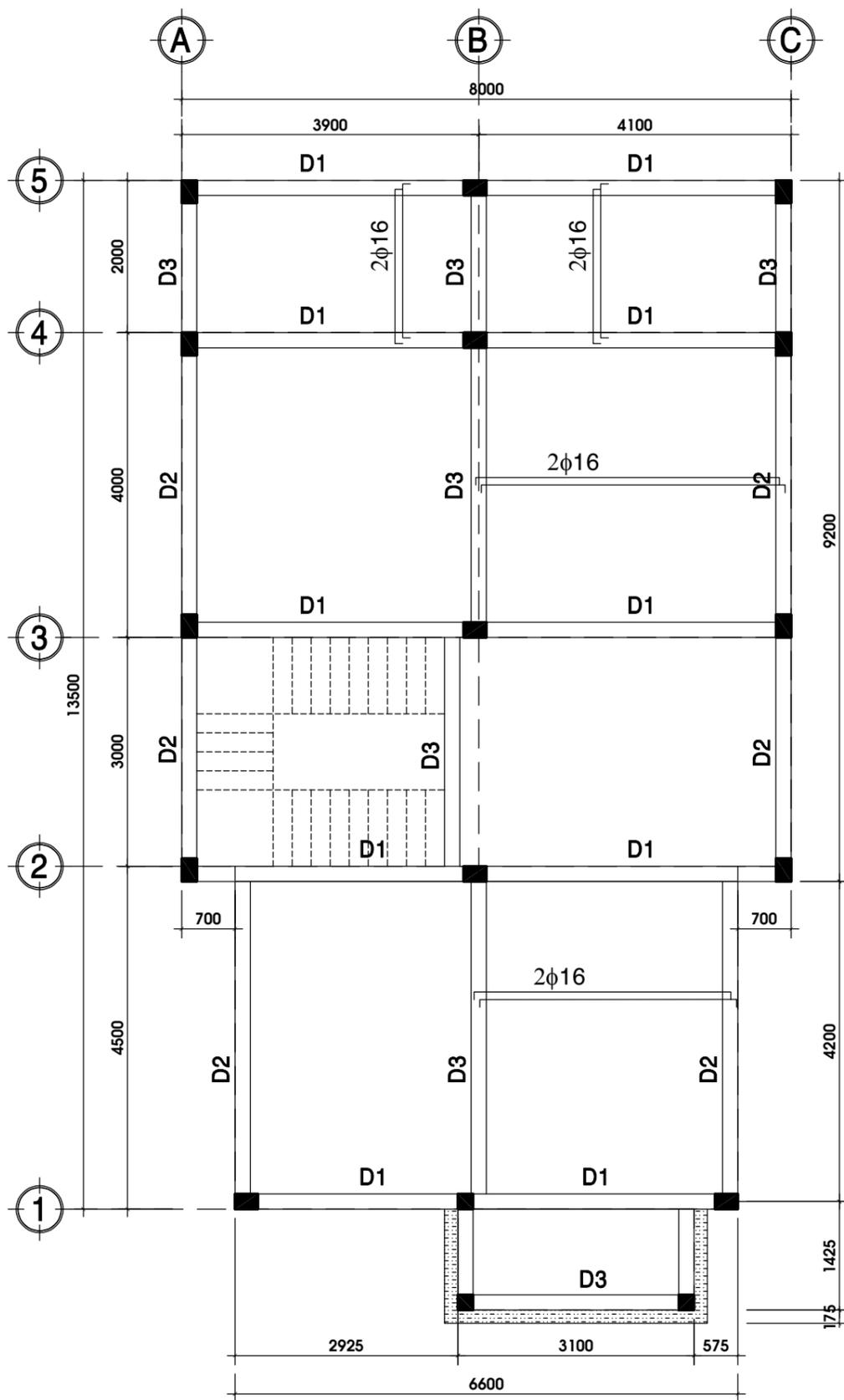
**MẶT BẰNG DẦM LẦU 1 TL : 1/100**
