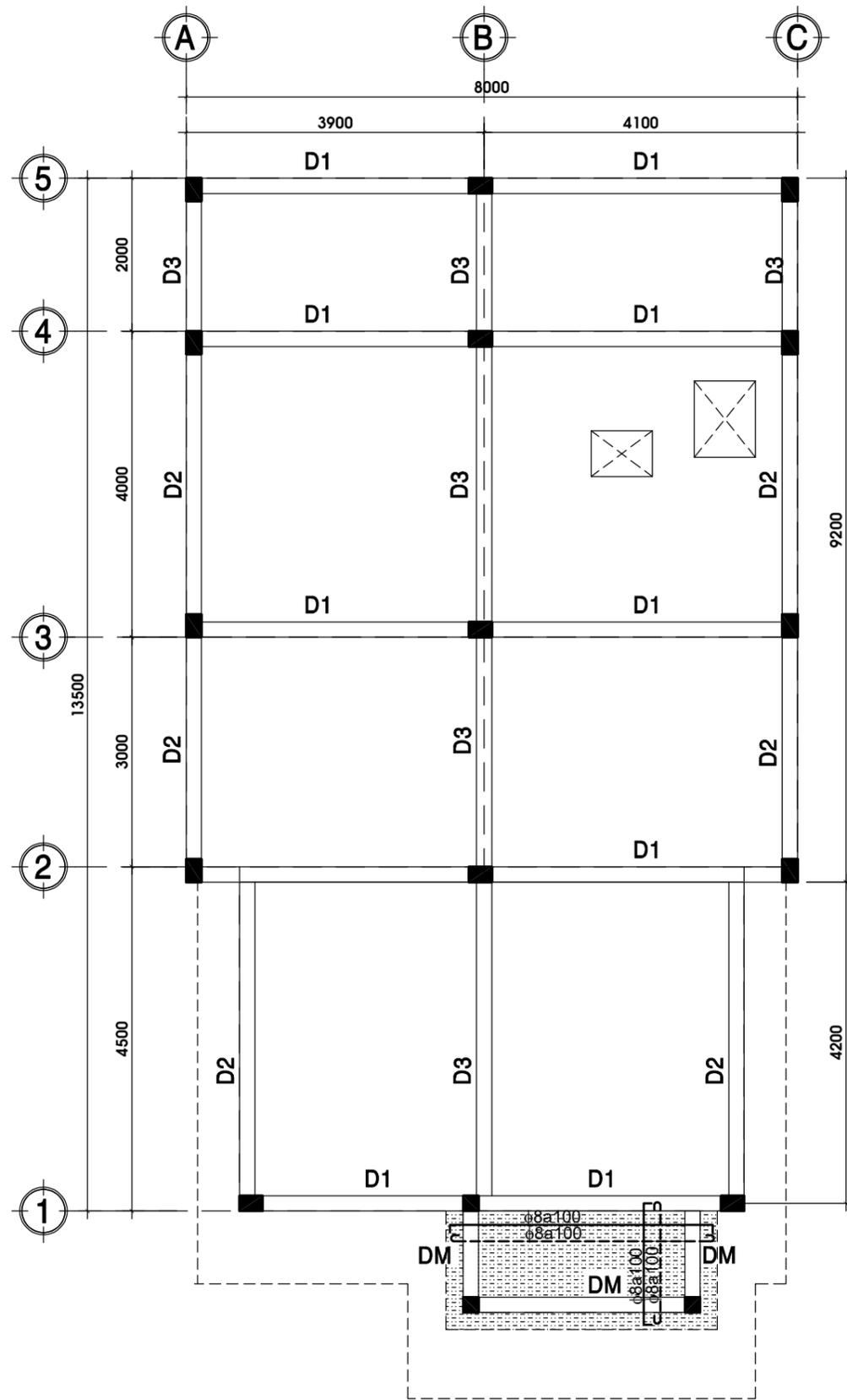
**MẶT BẰNG DẦM KHO MÁI TL : 1/100**
