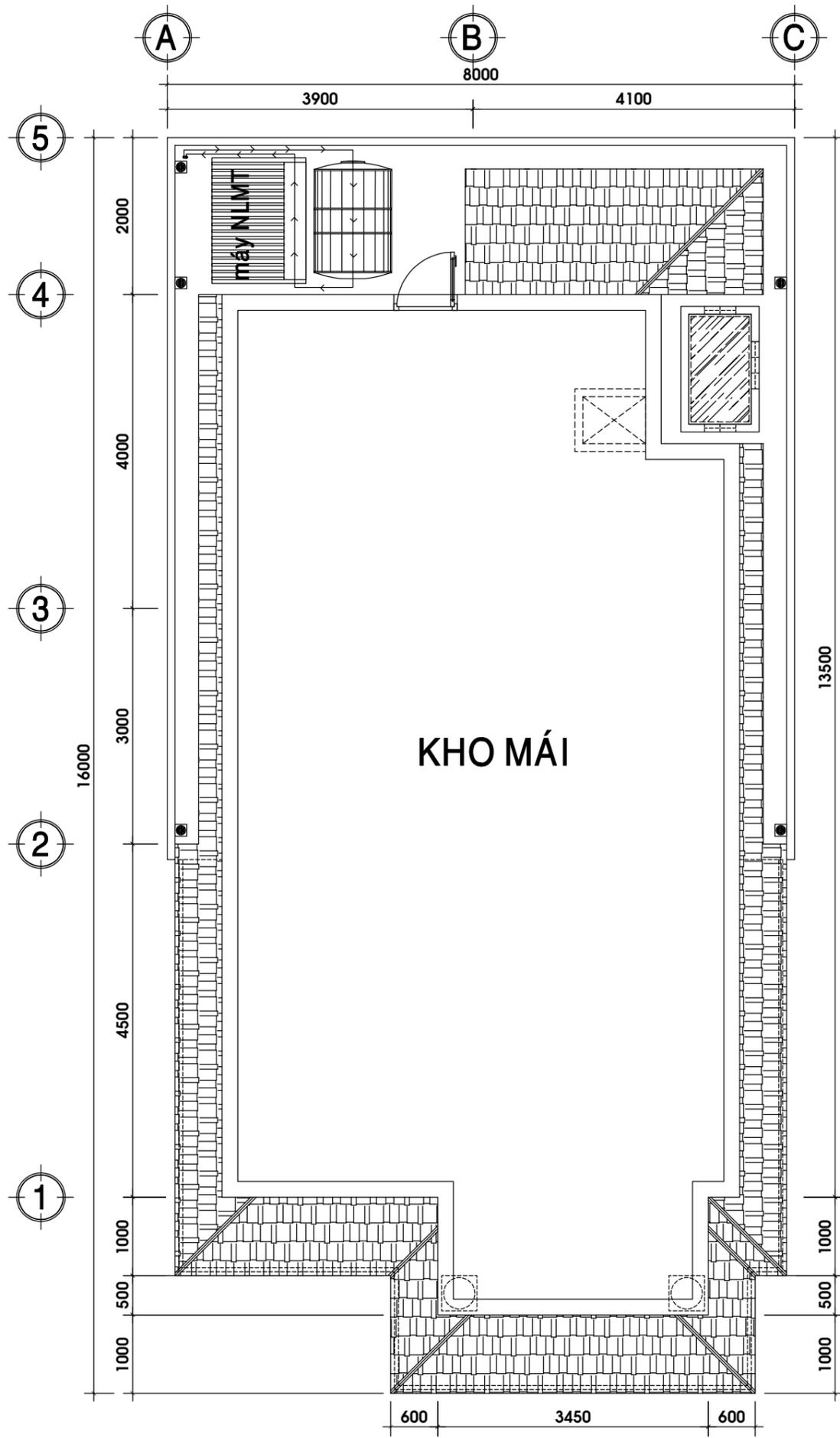
**MẶT BẰNG CẤP NƯỚC SÀN MÁI TL 1/100**
